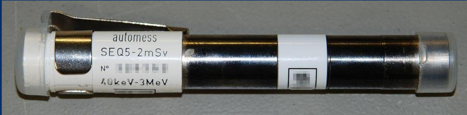
**Direct-reading Pocket Dosimeter**
