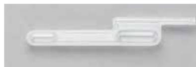
Micropipette à double bulbe de 60 µl
