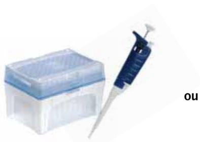
Micropipette de 100 µl avec embouts
