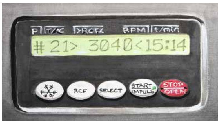
La centrifugeuse doit pouvoir atteindre et maintenir une FCR (force centrifuge relative) de 3040 pendant 15 à 20 minutes pour sédimenter la majorité des bacilles acido-alcool-résistants
