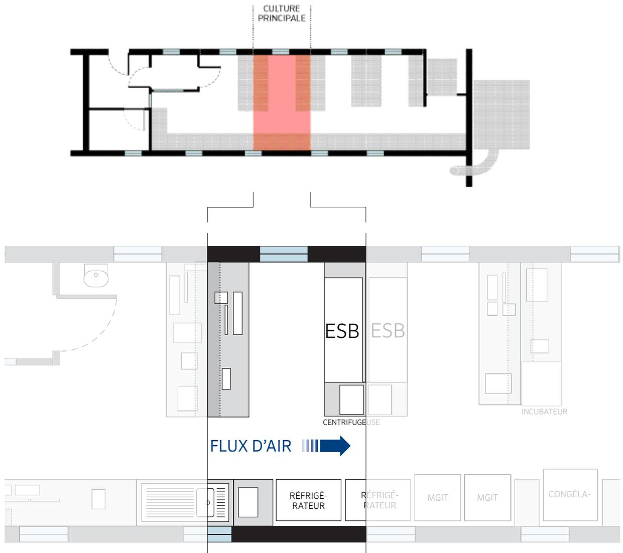
Les activités génèrent une faible concentration de particules infectieuses. Un équipement spécifique est nécessaire et tout traitement des échantillons doit être effectué au sein d'une ESB.
